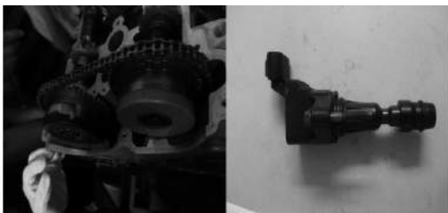
그림 4 SI엔진은 스파크 점화가 필요한데 점화 효율을 올리준다. 화coil이다.
